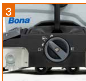
3. Nastavte střední úroveň tlaku kartáčů.
